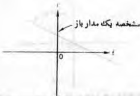
شکل ۱-۳ - مشخصه یک مدار باز منطبق بر محور v است
