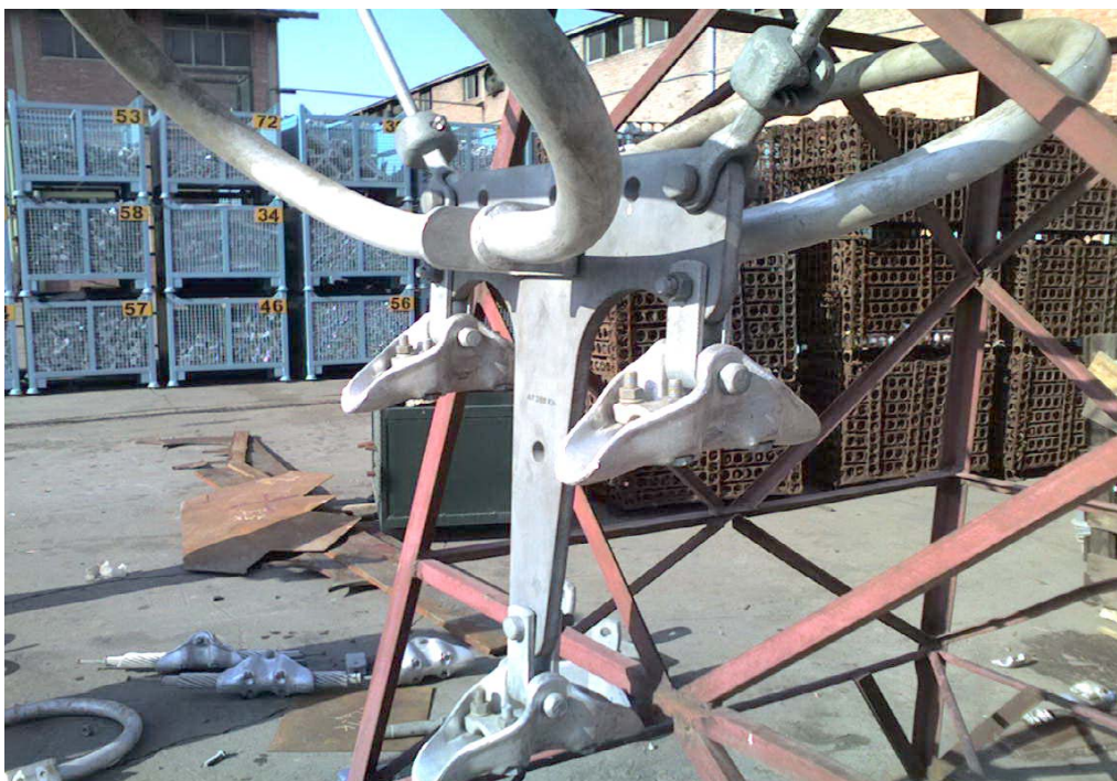
شکل ۴۱) استفاده از Socket Clevis , Yoke Plate , Arcing Rocket , Suspension Hinge , Suspension Clamp
