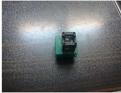
شکل (۴-۳۲) زیف یا سوکت قرار گیری آی سی EEPROM
