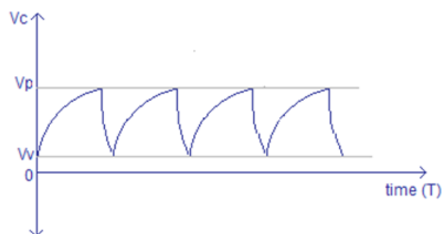
شکل موج ولتاژ دو سر خازن در PUT
