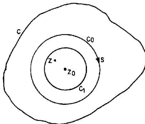
چون  $\left| \frac{z-z_0}{s-z_0} \right| < 1$  با ضرب طرفین این تساوی در  $f(s)ds$  و انتگرالگیری بر روی  $C$  و توجه به اینکه
