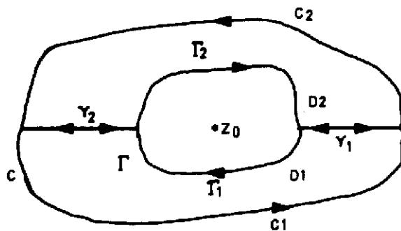
که در آن انتگرال‌گیری بر  $C$  و  $\Gamma$  در جهت‌های مثلثاتی است. با رسم منحنی‌های  $\gamma_1$  و  $\gamma_2$  حلقه واقع بین دو منحنی  $C$  و  $\Gamma$  را به دو ناحیه  $D_1$  و  $D_2$  تبدیل می‌کنیم و به علت تحلیلی بودن  $f(z)$  بر این دو ناحیه و مرز آنها مقادیر انتگرال تابع  $f(z)$  بر روی این مرزها صفر است و با انتگرال‌گیری بر روی  $\gamma_1$  و  $\gamma_2$  دو جهت مختلف مختلف می‌یابیم
