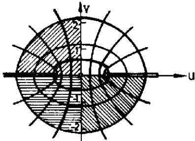
نقطه  $A'$  و نقطه  $B$  متناظر با  $x=c' < \pi < \frac{\pi}{2}$  به نقطه‌ای در ربع چهارم صفحه  $w$  تبدیل می‌شود. خط  $x = \frac{\pi}{2}$  به نیم خط  $u = \cosh y \geq 1$  و  $v = 0$ ، خط  $x = -\frac{\pi}{2}$  به نیم خط  $u = \sinh x \leq 1$  و  $v = 0$  نیز به پاره خط  $u = -\cosh y \leq -1$  و  $v = 0$  تبدیل می‌شود.
