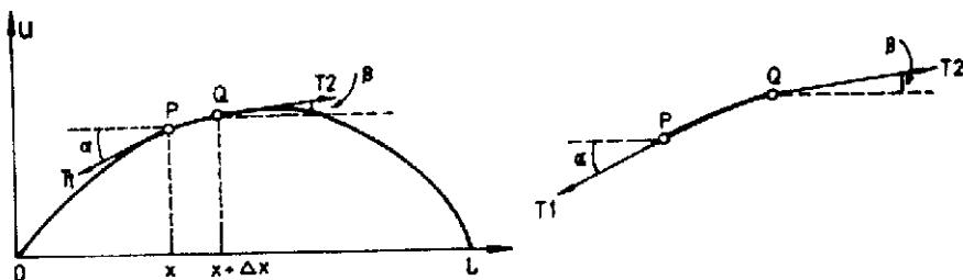
هرگاه نیروهای کشش با مقادیر  $T_1$  و  $T_2$  به ترتیب در نقاط  $x$  و  $x + \Delta x$  برابر نخ وارد شوند آنگاه به علت عدم وجود حرکت در امتداد افق، تصویر نیروی کشش در طول محور  $x$  دارای اندازه ثابت  $T_1 \cos \beta = T_2 \cos \alpha = T$  است و نیروی محرکه در امتداد قائم که بر اثر نیروی کشش ایجاد می‌گردد برابر
