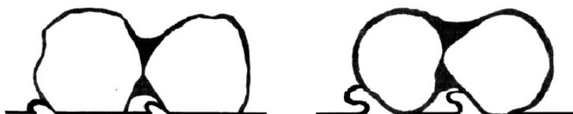
سرعت تیز کردن سنگ کم بوده است. سرعت تیز کردن سنگ زیاد بوده است.
