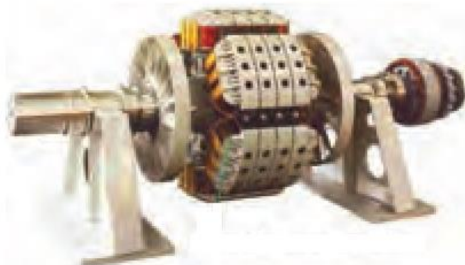
شکل ۳-۵ - رتور قطب برجسته
