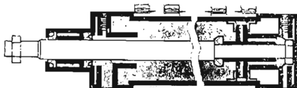
شکل ۱۱۶- سیلندر دو طرفه با سنسورهای موقعیت میدان مغناطیسی.
