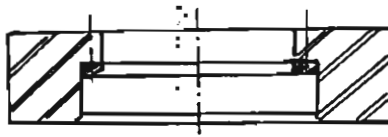
(شکل ۶۹) - ماتریس کششی چدنی با بیرون انداز حلقه ای
