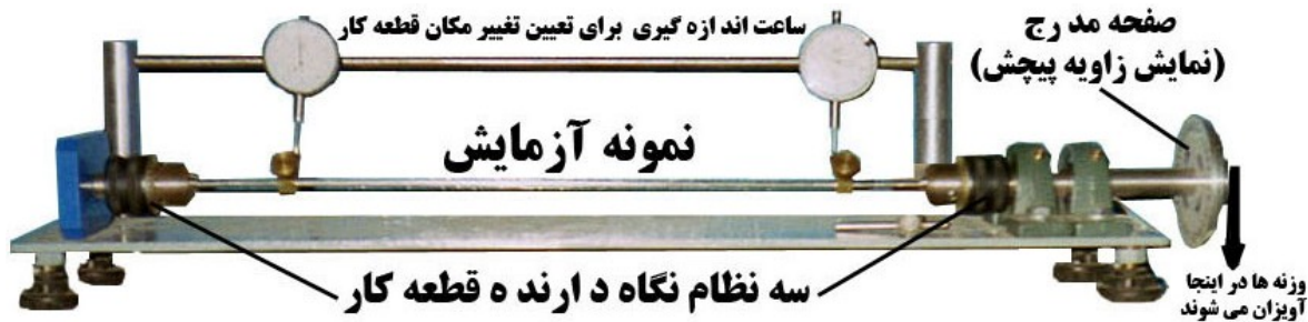
شکل (۱) دستگاه آزمایش پیچش آموزشدهنده فنی شهید بهشتی کرج
